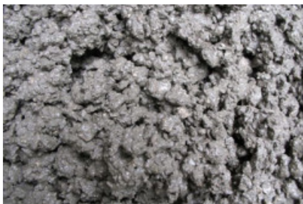
Рис. 2. Крупнозернистый жаропрочный бетон смешивается с водой в заданной пропорции и перемешивается механической мешалкой.[6]
