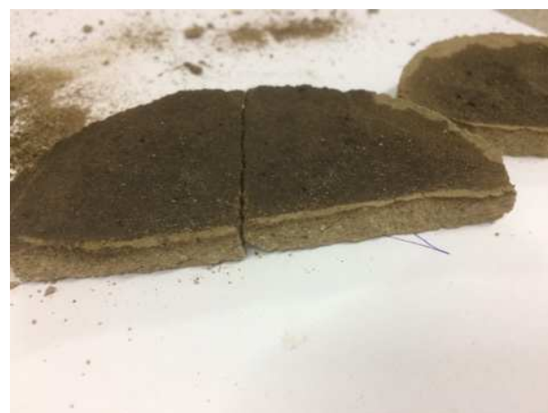
Рис. 6. Глубина проникновения нефти через 2 часа после внесения сорбента
