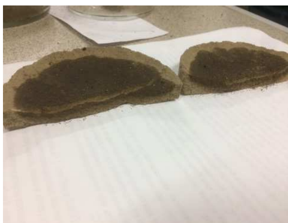
Рис. 5. Глубина начального проникновения нефти в почву
