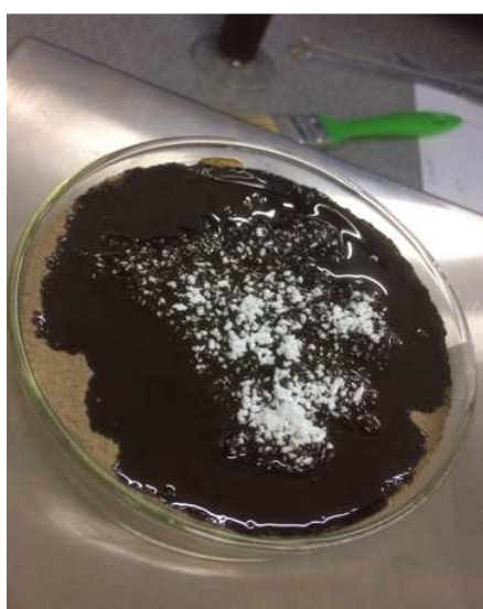
Рис. 1. Внесение сорбента на поверхность нефти, разлитой на почве
