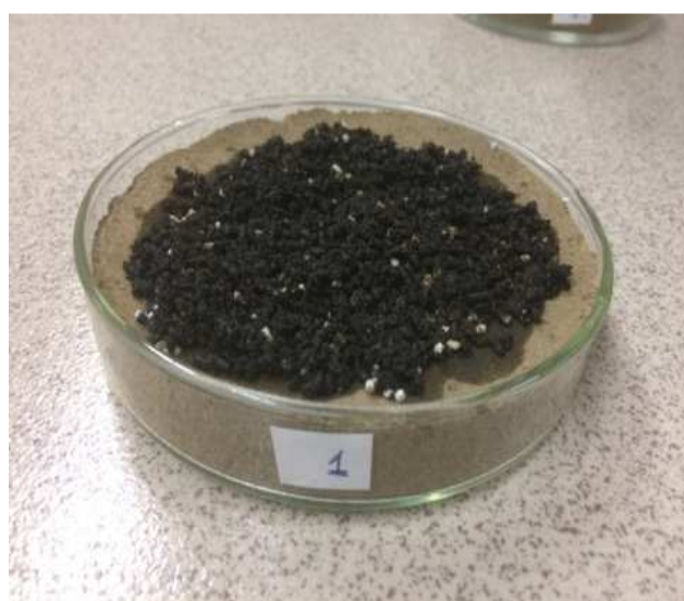
Рис. 2. Окончание процесса сорбции нефти
